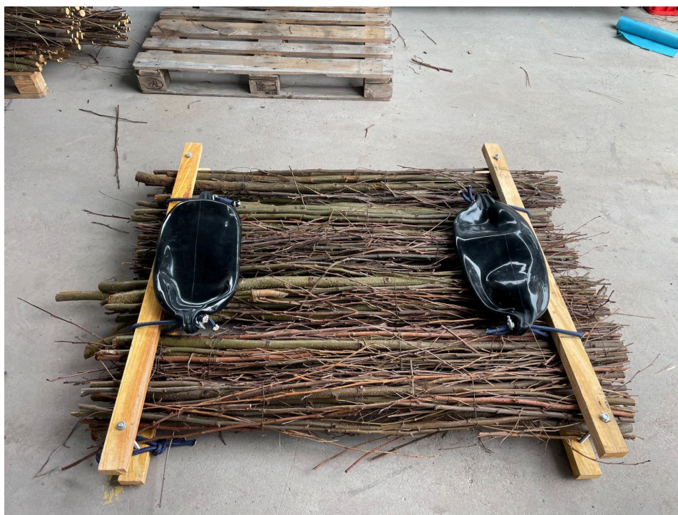
Fot. 2. Gotowa konstrukcja tratwy z dwoma odbijaczami (źródło: H2O SCITECH)
