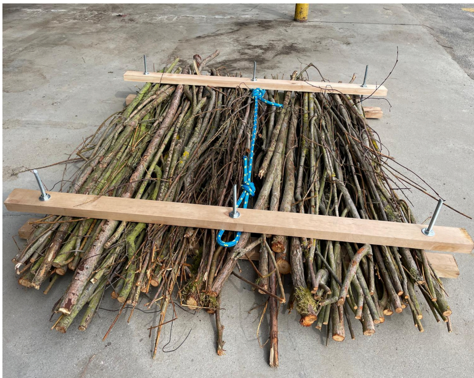
Fot. 2. Prototyp tratwy – element roślinnej wyspy filtracyjnej (źródło: H2O SCITECH)
