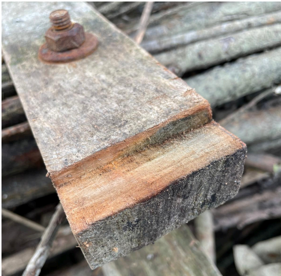
Fot. 16. Stan drewna olchowego i śrub po zbiorze wysp (źródło: H2O SCITECH)
